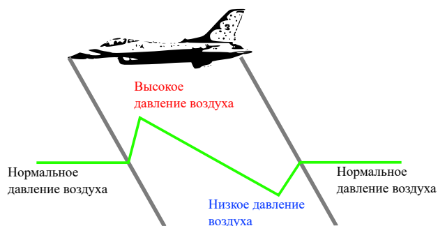
Рис. 1. Схема «звукового удара», создаваемого самолетом
